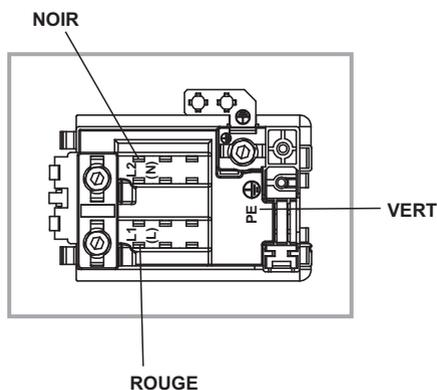
Pour la plaque à induction, le câble doit être de type AWG / 60227 IEC 53. Le diagramme de branchement est situé à l'arrière de l'appareil.
