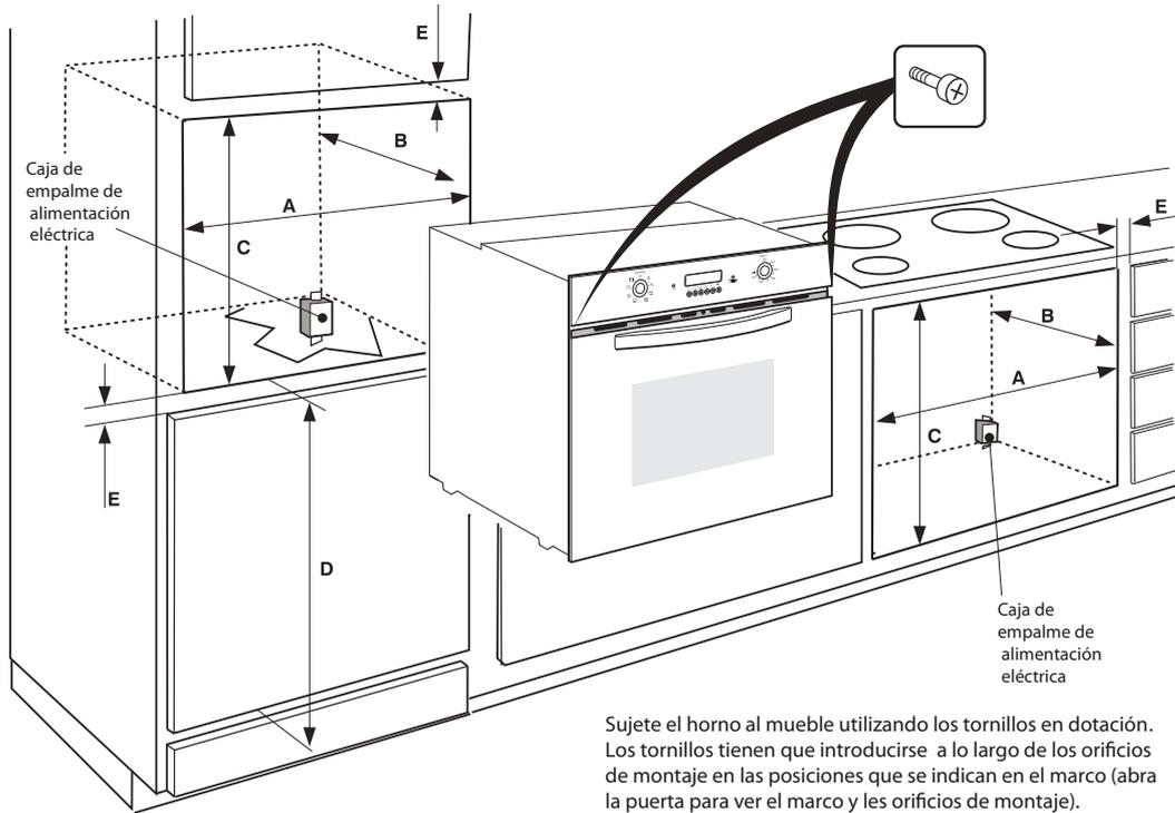
Sujete el horno al mueble utilizando los tornillos en dotación. Los tornillos tienen que introducirse a lo largo de los orificios de montaje en las posiciones que se indican en el marco (abra la puerta para ver el marco y los orificios de montaje). No apriete en exceso los tornillos.
