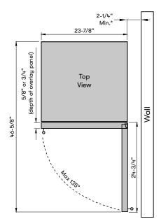
\*When using an optional Zephyr handle
